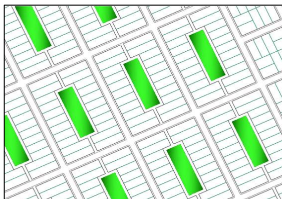
Figura 7 - Loteamento ecológico: vista parcial da disposição dos lotes e das praças, na área central de cada quadra
