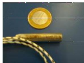
**Figura 08 – Resistência tubular com 40W para geração de calor nos ensaios**
