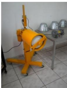
**Figura 06 – Moinho de bolas de Aço para ajuste dos agregados**
