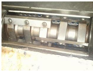
**Figura 02: Moinho montado com facas alternadas. Motor 7,5cv e 3.750 rpm. Produz 300, 0kg/h.**
