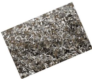
**Figura 01: Cavacos de torno mecânico, provenientes da usinagem de peças de alumínio.**
