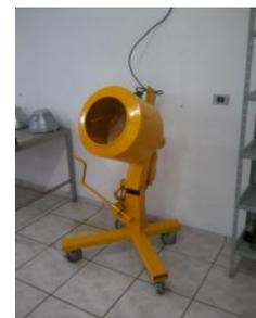
**Figura 09 - Argamassadeira basic., cap. de 50l.**
