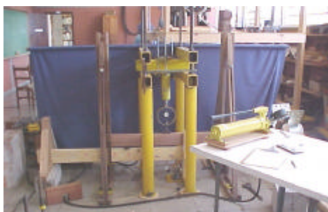
Figura 4 – Arranjo dos testes de flexão estática em relação ao eixo de maior inércia.
