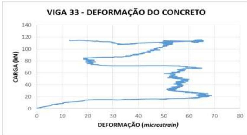
Figura 13 – Curva (Carga x Deformação) da fibra 2A da viga reforçada n° 33
