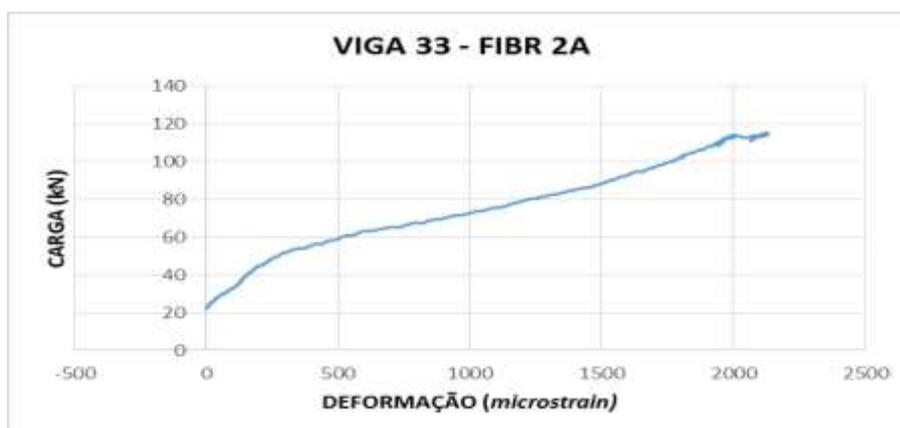
Figura 12 – Curva (Carga x Deformação) da fibra 2A da viga reforçada n° 33
