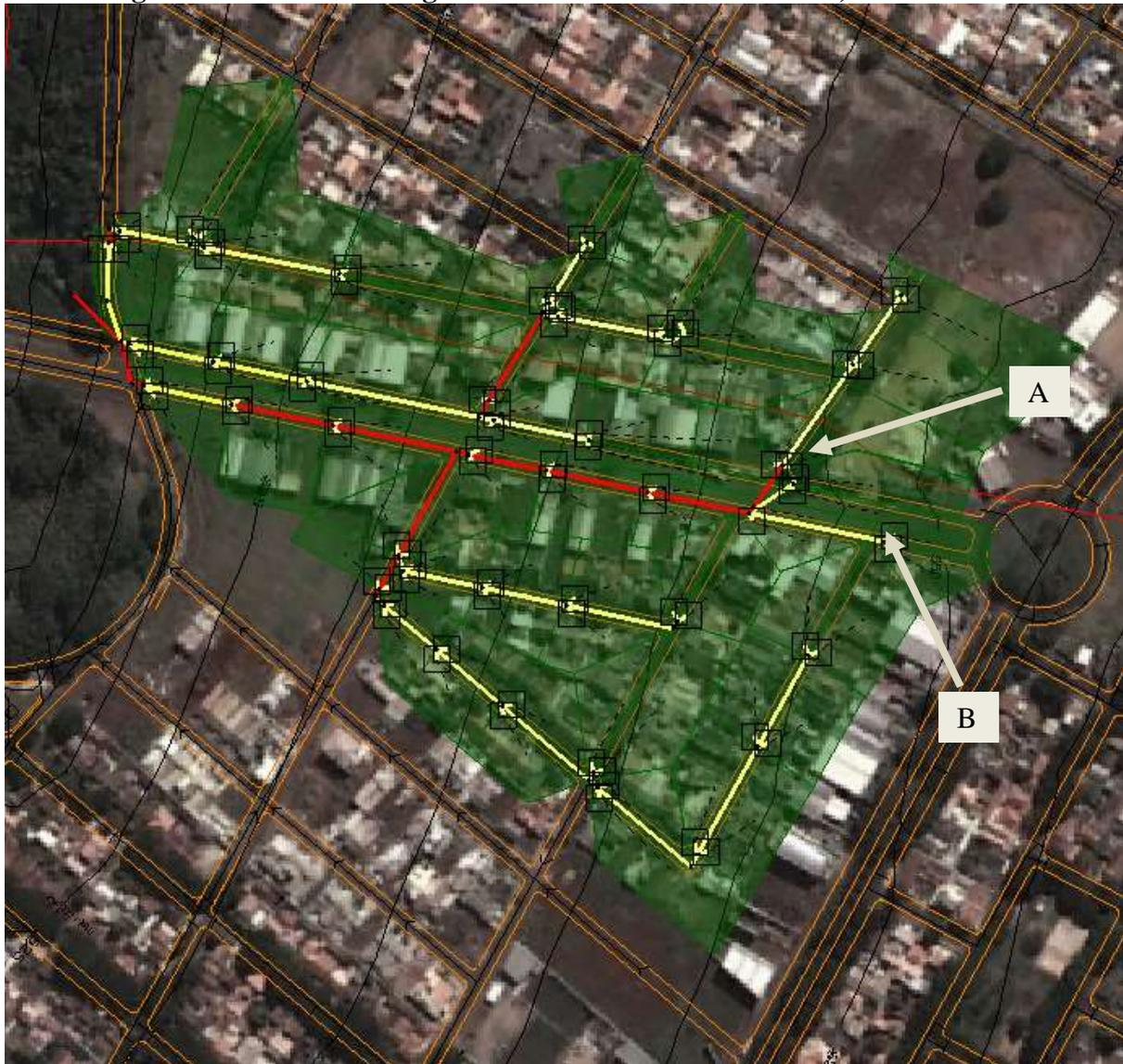
Na Figura 4 é apresentado um dos trechos da rede de drenagem do loteamento Porta do Céu e seu perfil, onde a linha azul representa a linha piezométrica e a linha vermelha representa a linha de energia. A superfície do terreno corresponde à linha verde na imagem do perfil. Observa-se que o trecho analisado nesta figura corresponde à seleção em azul na imagem de satélite da mesma figura. Observa-se também que os tubos estão funcionando a seção plena e não a 75% da seção.
