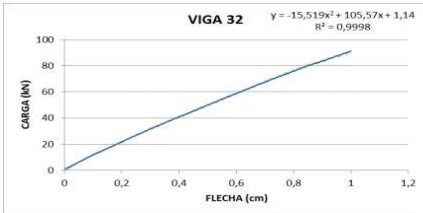
**Figura 7 – Curva (Carga x Deformação) do estribo 1 da viga reforçada nº 32.**
