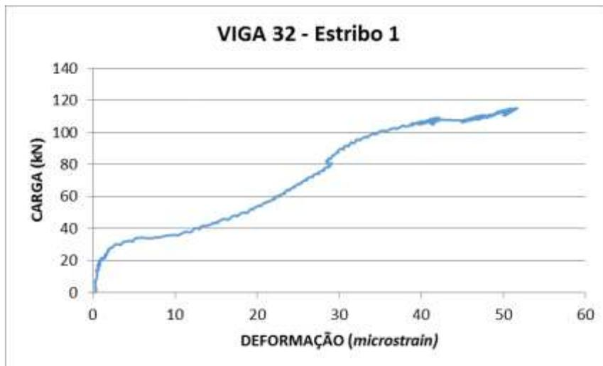
**Figura 8 – Curva (Carga x Deformação) da fibra 2A da viga reforçada nº 32**
